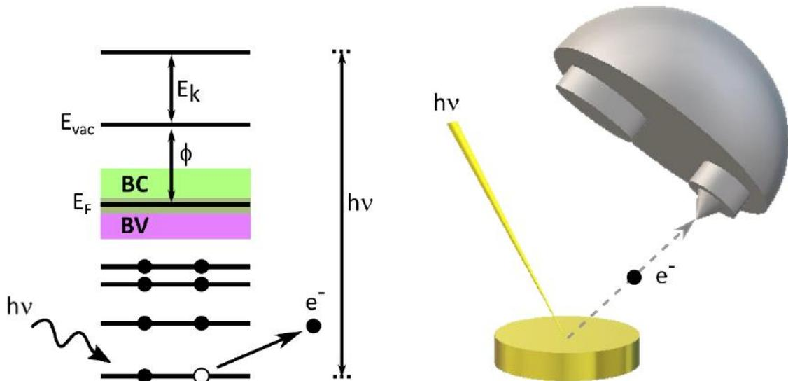
Figura 4. Izquierda: diagrama de niveles de energía para una muestra conductora en el que se esquematiza el proceso de fotoemisión desde un nivel interno. Derecha: un haz de fotones incide sobre una muestra y los fotoelectrones emitidos son colectados por un analizador de electrones.
