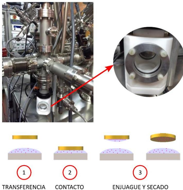
Figura 2. Arriba: Celda líquida de la cámara de ultra alto vacío. Abajo: pasos del proceso de contacto de la solución con la superficie a estudiar.<sup>49</sup>
