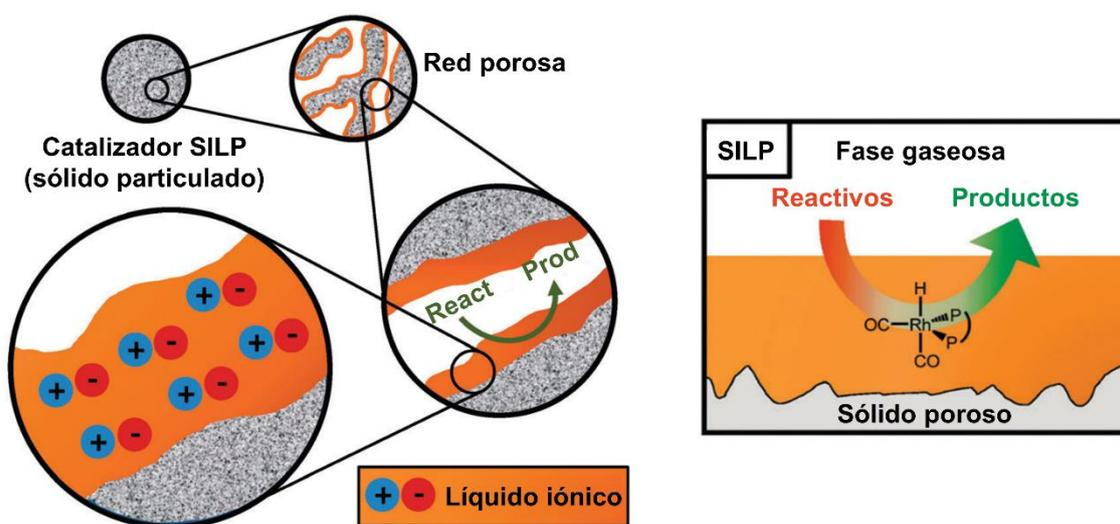
Figura 2. Descripción esquemática del catalizador para reacciones en fase homogénea tipo SILP utilizando como ejemplo un complejo de Rh.<sup>22</sup>
