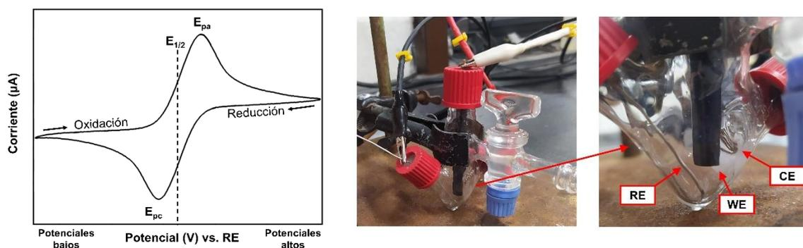
Figura 10. Izquierda: voltamperograma cíclico típico para una cupla redox reversible.  $E_{pa}$  = potencial del pico anódico,  $E_{pc}$  = potencial del pico catódico y  $E_{1/2}$  = potencial medio. Derecha: arreglo experimental de la celda electroquímica utilizada para las voltametrías cíclicas de esta tesis. WE: electrodo de trabajo de carbono vítreo, RE: electrodo de pseudo referencia de plata y CE: contra electrodo de platino.
