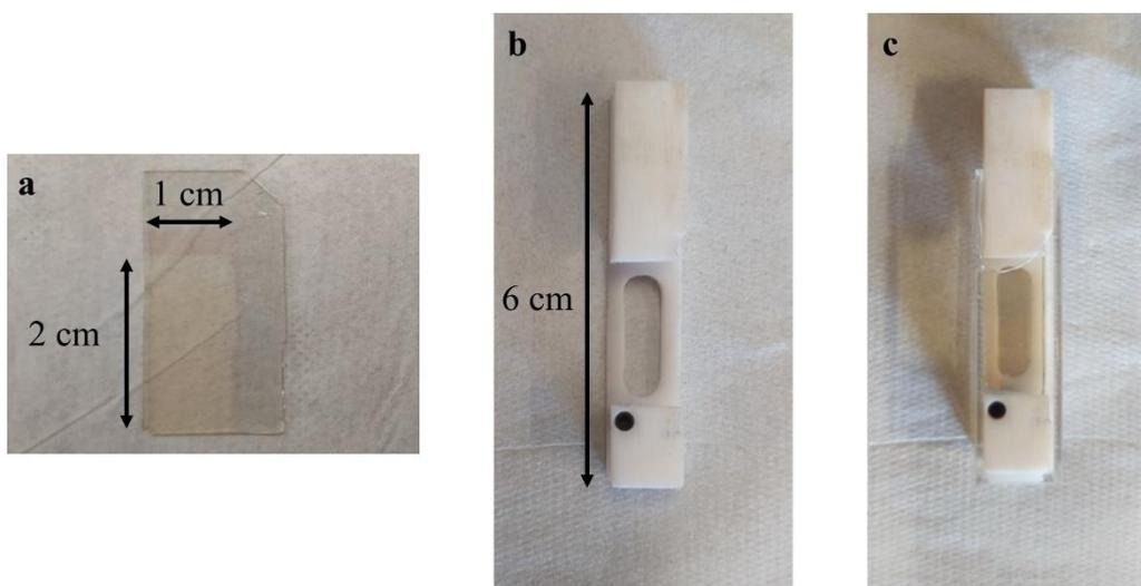
Figura 3. a) film de  $\text{TiO}_2$  mesoporoso sobre FTO/vidrio funcionalizado con Ru-CN. b) soporte de teflón utilizado para sostener el film dentro de la cubeta del espectrofotómetro. c) sistema completo con el film en el soporte de teflón dentro de la cubeta de cuarzo.
