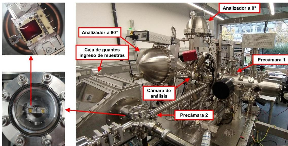
Figura 3. Cámara de UHV del sistema DASSA de la cátedra de Química Física II de la Universidad de Erlangen-Nürnberg (FAU).
