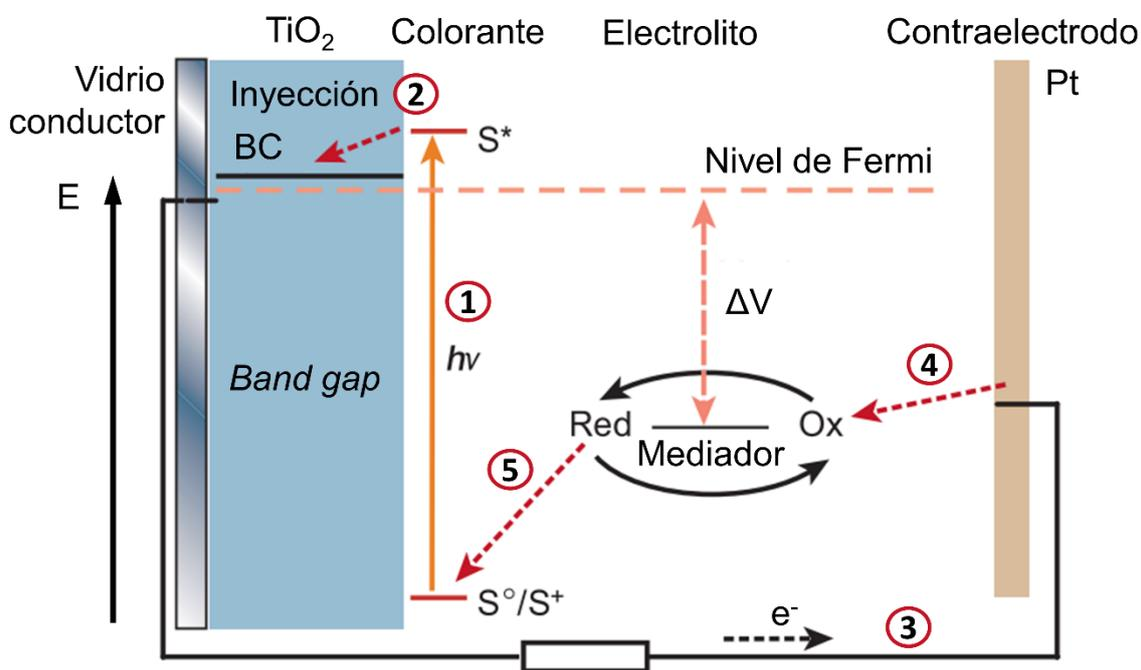
Figura 1. Esquema de una celda fotovoltaica de  $\text{TiO}_2$  mesoporoso sensibilizada por un colorante.<sup>12</sup>
